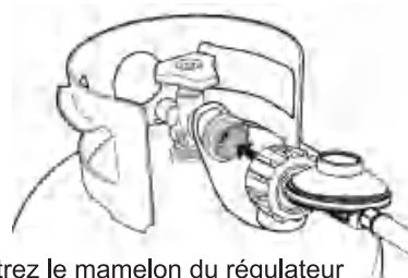
Centrez le mamelon du régulateur dans la vanne de bouteille.
